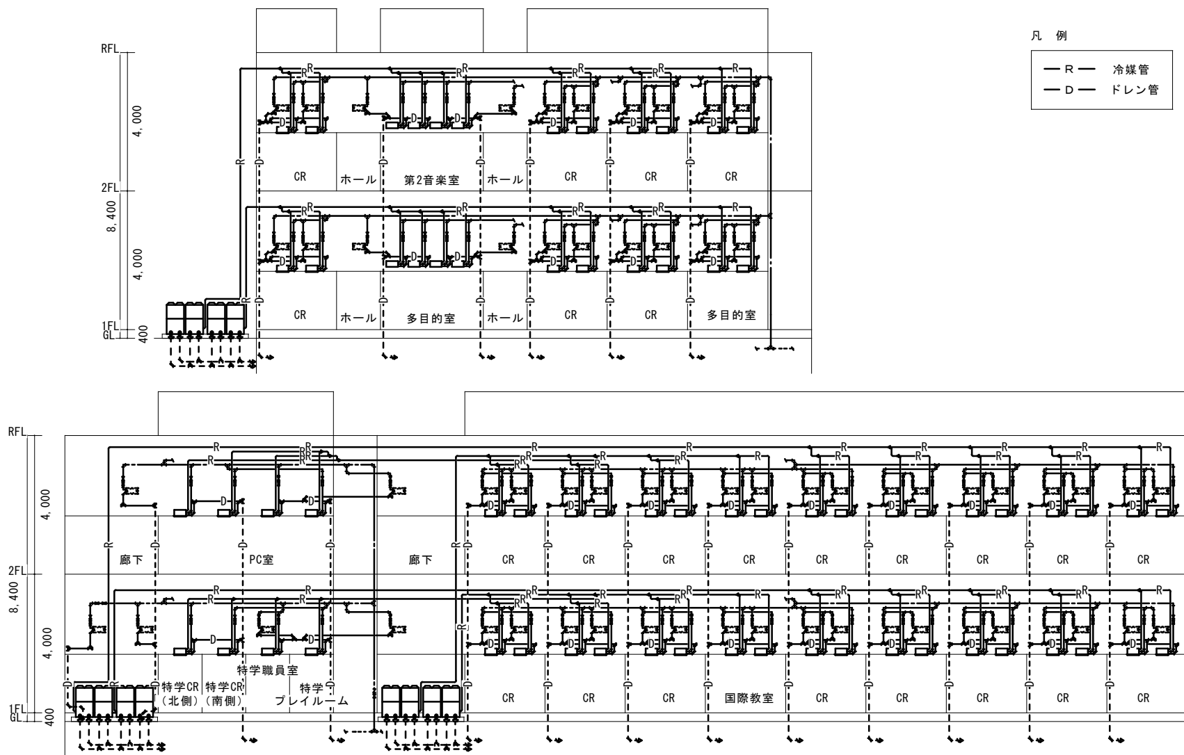
空調設備系統図（普通教室系統）
