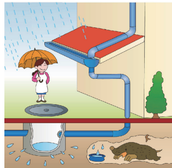
雨水浸透施設 設置イメージ
